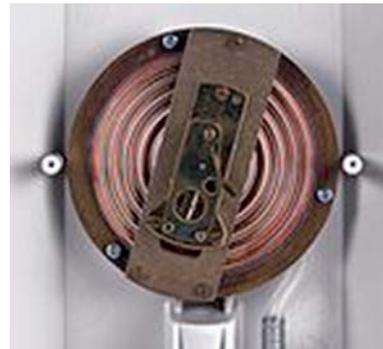
La fijación del mecanismo de precisión sobre un puente metálico sólido y la membrana de presión extragrande garantizan la posición de cero de la aguja de modo seguro.
